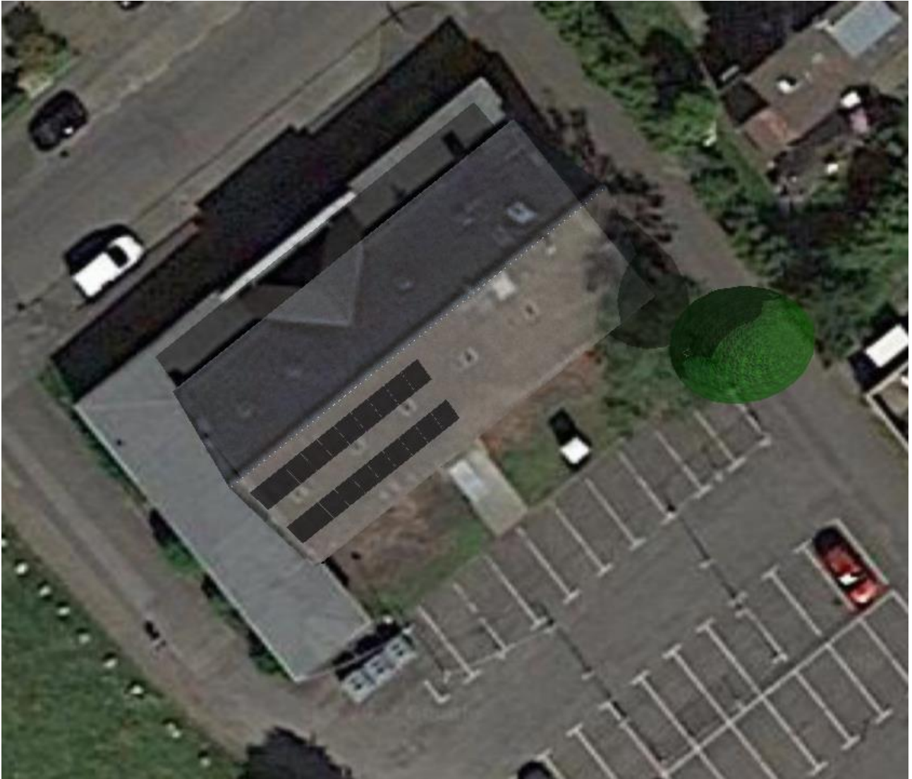
Abbildung 12: PV-Anlage – genordete Draufsicht Variante „wirtschaftlich optimiert“ (PVsol*premium)
