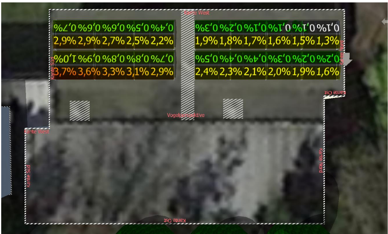
Abbildung 12: Verschattungsanalyse Flachdach I Aufständigung Ost/West („wirtschaftlich optimiert“)
