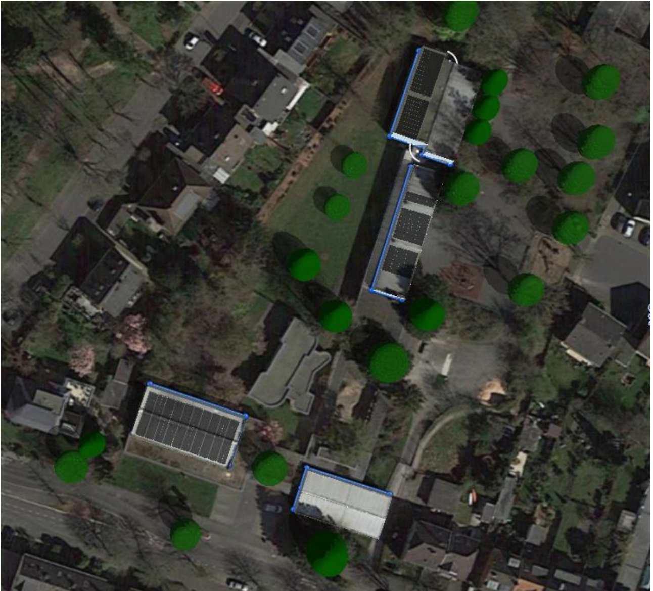
Abbildung 19: PV-Anlage – genordete Draufsicht Variante „Maximale Anlagengröße“ (PVsol*premium)
