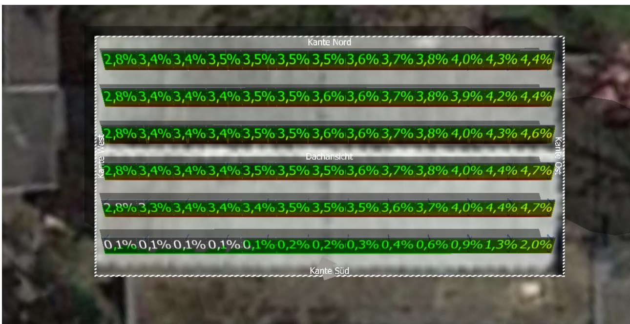
Abbildung 17: Verschattungsanalyse Flachdach IV Aufständering Süd („wirtschaftlich optimiert“)
